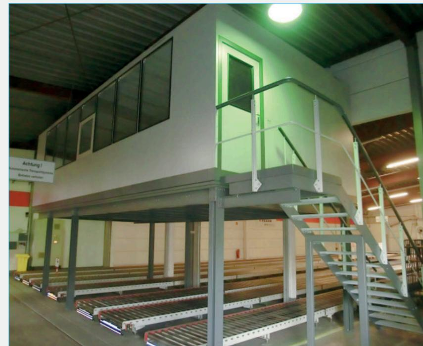
Schallschutzkabine: sperrt störenden Lärm ein
